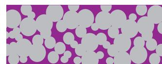
Adaugarea de SurfaMix® C in amestec controleaza reactia apei cu materialele pe baza de ciment, micsorand contractarea rapida a acestora. In acelasi timp, o pelicula de fixare umple gurile microscopice din amestec, mreste elasticitatea materialului si imbunatatesta aderenta la suprafetele de aplicare.
